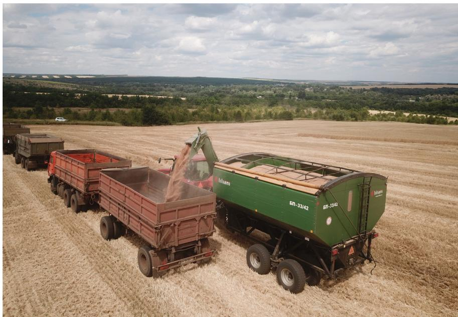
Перегрузчики зерна ЛИЛИАНИ оптимальны для сева: скоростной загрузки сеялок, посевных комплексов удобрениями и семенами, инокуляции и протравливания семян, подготовки тукосмесей из различных удобрений. Эффективны при трёхзвенной уборке, сокращают время сбора урожая до 50%. Бункер-перегрузчик LILIANI принимает зерно из комбайна, транспортирует к краю поля, перегружает в зерновоз, повышает производительность комбайнов на 40%, а также вдвое увеличивает оборачиваемость автотранспорта.
