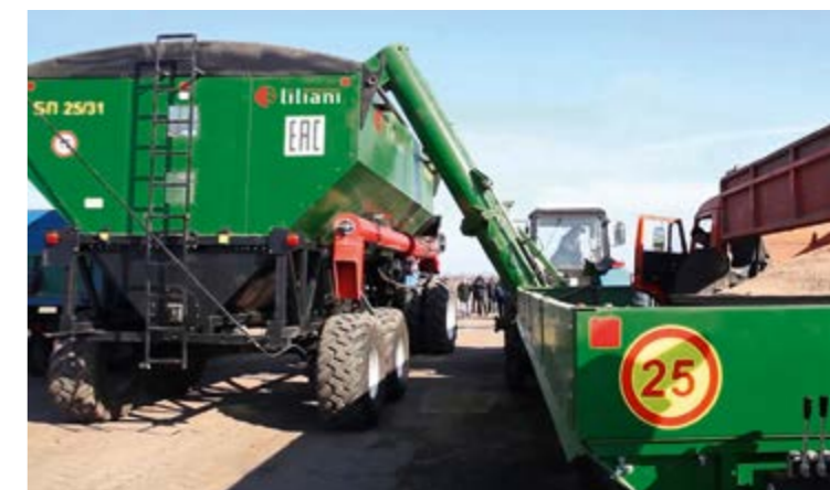
Загрузка бункера-перегрузчика «Лилиани» с помощью автомобильного перегрузчика МВА.
