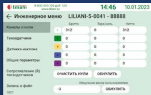
Инженерное меню. Точная настройка блока управления весовой системы датчиков.
